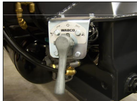
Abb.9: Drehschieberventil in Fahrstellung
