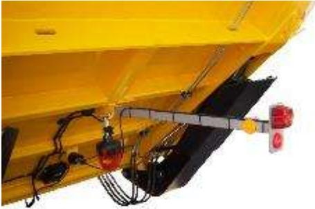
Die dritte Rückleuchte wird beim eingeklappten Bunker in die dafür vorgesehene Halterung gesteckt.
