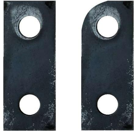
Anstelle der regulären und kalt getemperten Schlegel besteht auch die Möglichkeit den Rotor mit Widia-Schlegeln auszustatten. Hierbei ist darauf zu achten, dass bedingt durch das einseitig aufgebrauchte Hartmetallstück, zwar eine erhöhte Standzeit erreicht wird, es aber nicht möglich ist den Schlegel zu drehen und zwei- bzw. vierfach zu verwenden.
