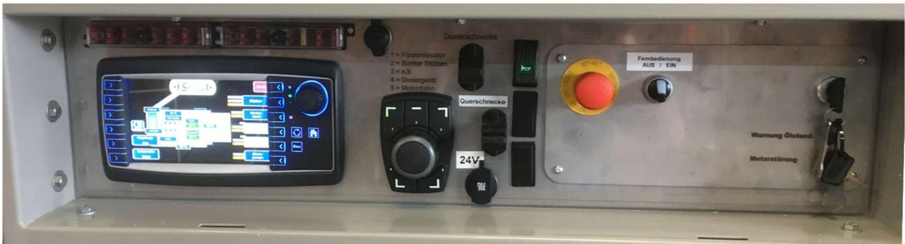
Im Fall einer zusätzlich verbauten Funkfernbedienung wird über einen Drehknopf die Bedienung freigeschaltet, entweder nur für das Terminal oder nur für die Fernbedienung. Dies ist ein Sicherheitsmechanismus um eine Doppelbedienung zu verhindern. Nähere Informationen erhalten Sie in **Kap. 6.3**.
