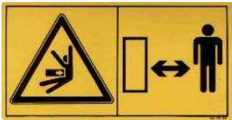
**Achtung:** Ausreichenden Sicherheitsabstand zum Schwenkbereich der Maschine einhalten!
