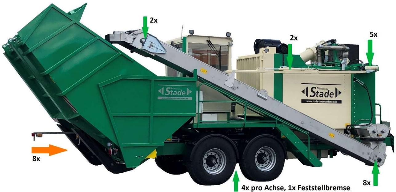
Standardschmierstellen bei Mahlanlage mit festem Bunker(**grüne Pfeile**). Zusätzliche Schmierstellen bei Anlagen mit Klappbunker(**oranjer Pfeil**).
