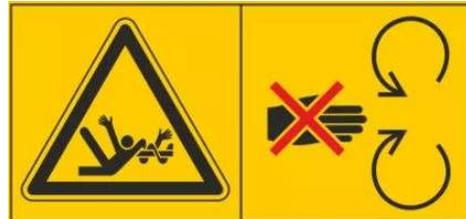
**Achtung:** Niemals in die sich drehende Schnecke greifen! Während des Betriebes Schutzeinrichtungen nicht öffnen oder entfernen!
