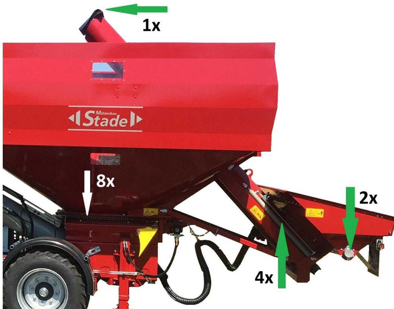
Pour les trémies rotatives, les points de graissage standard du premier graphique sont complétés par ceux mentionnés ici (flèches vertes et blanches). Les chaînes d'entraînement de la vis d'alimentation, de la vis de dosage et de l'unité de broyage doivent être graissées toutes les 10 heures de service !
