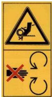
**Attention :** ne pas ouvrir ni ôter les protections de sécurité lorsque la machine est en marche !
