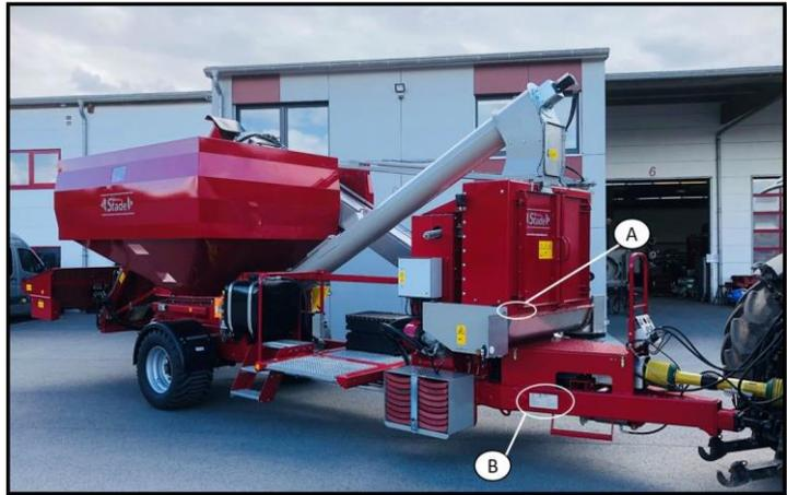
Un numéro à quatre chiffres est marqué en bas à gauche sur le corps de broyeur (A) pour identifier le groupe de broyage.
