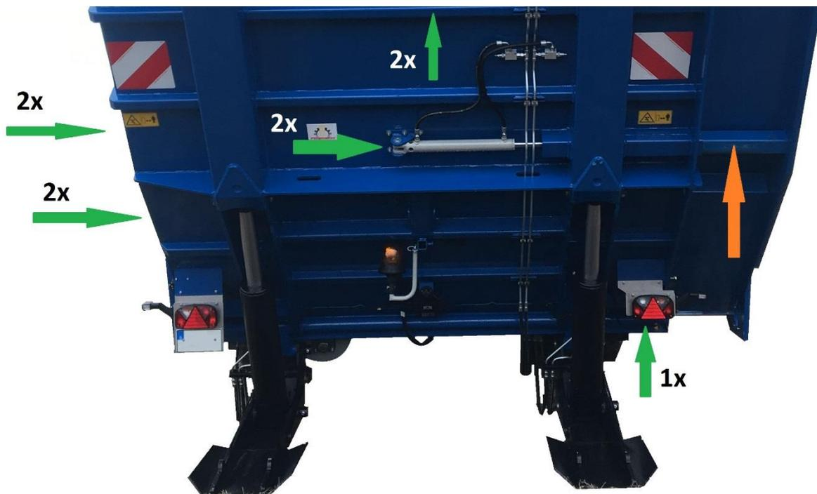
Pour les installations de trémies télescopiques, les points de graissage indiqués sur l'illustration (flèche verte) viennent s'ajouter aux points mentionnés. Il faut tenir compte des points de graissage situés à l'arrière de la trémie, ainsi que de la surface marquée (flèche orange).
