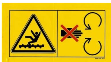
**Attention :** ne pas ouvrir ni ôter les protections de sécurité lorsque la machine est en fonctionnement !
